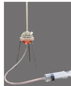
図4. 実験装置をセットしたようす。わかりやすくするために食用色素で重曹の水溶液に色をつけてある。
