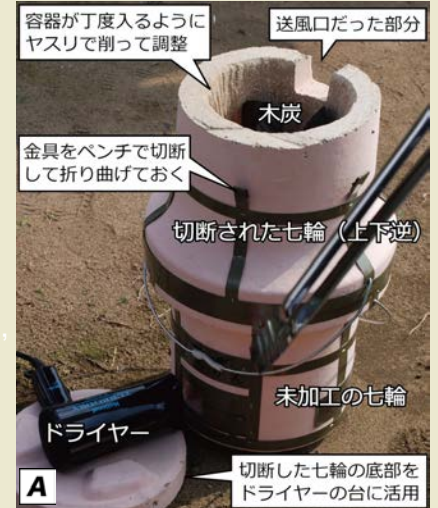
図28 2つの七輪を組み合わせて作った実験装置。切り落とした七輪の底は送風機のだい台として使えます。
