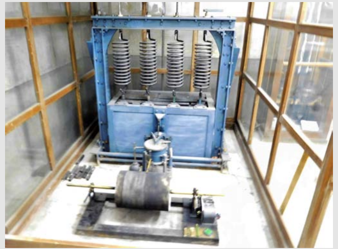
図10 ハルタ山に設置されている機械式上下動地震計（佐々式）。煤書きにて地震波形が記録される。
