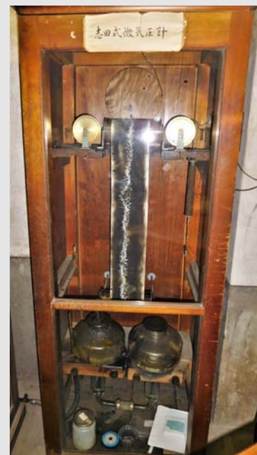
図11 ハルタ山に設置されている微気圧計（志田式）。煤書きにて気圧変化が記録される。
